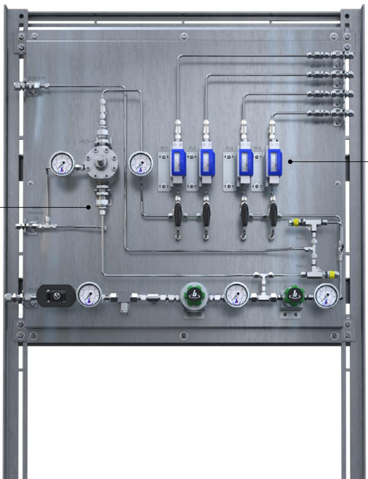
Diese Produkte bieten alle Funktionen des ECPc-Portfolios, mit dem zusätzlichen Vorteil den Stickstoffdruck zu den Hauptpackungen dynamisch zu regulieren, und zwar immer bei einem Bar oder 15 PSI oberhalb des Fackelgegendrucks. Dies gewährleistet eine Minimierung des Stickstoffverbrauchs, sowie verbesserte Möglichkeiten zur Überwachung des Zustandes des Verdichters. Sie sind die perfekte Lösung für die meisten Prozessgasanlagen in Raffinerien oder petrochemischen Anlagen.
